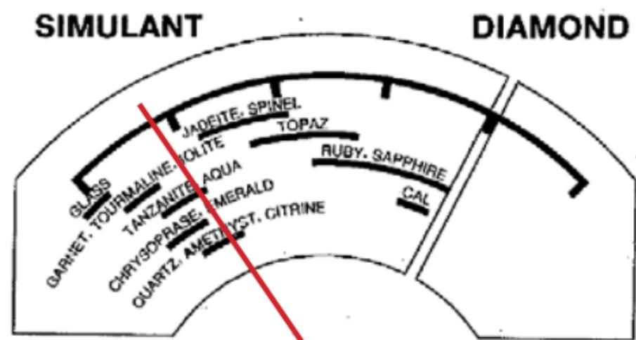
Wenn die Anzeige an der oben gezeigten Position stehen bleibt, kann das Prüfobjekt aus Quarz, Amethyst, Citrin, Tanzanit oder Aqua usw bestehen, d. h. aus jeder Sorte, die innerhalb des weißen Streifens liegt, den die Nadel überquert.
