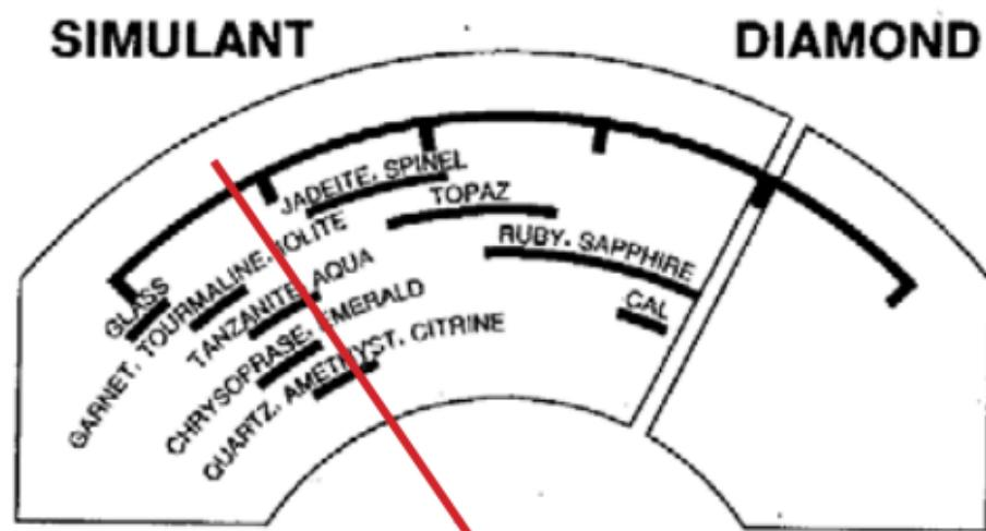
Quand l'aiguille s'arrête dans la position ci-dessus, la pierre testée peut être du quartz, une améthyste, une citrine, une tanzanite ou aigue-marine, c'est-à-dire n'importe quelle pierre se trouvant dans la zone blanche dans laquelle passe l'aiguille.
